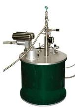
带VTT变温腔体超导磁体
